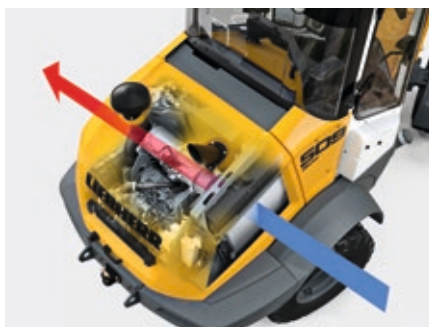
L'installation de réfrigération L 507/L 509
